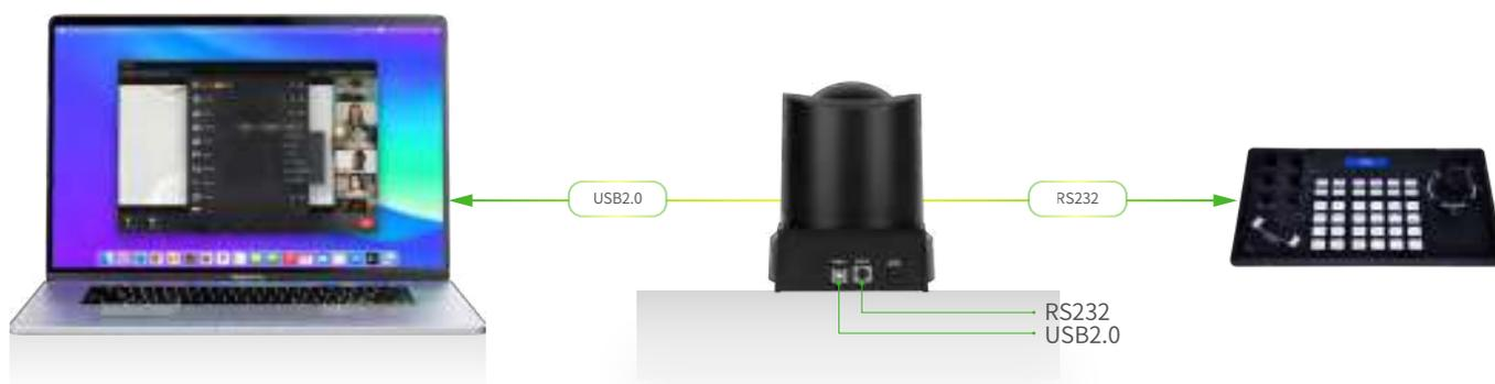
摄像机支持RS232串口，可配备遥控键盘实现对摄像机的控制，如镜头转动、变焦等
